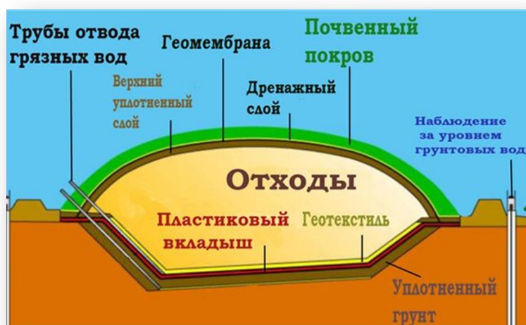
Рис. Строение полигона ТКО
