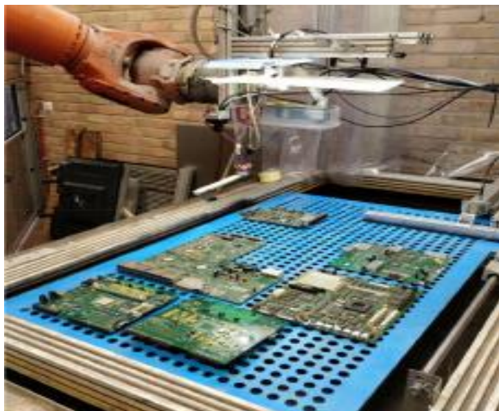
Рис. 1. Настройка робота для получения изображения РВВ
