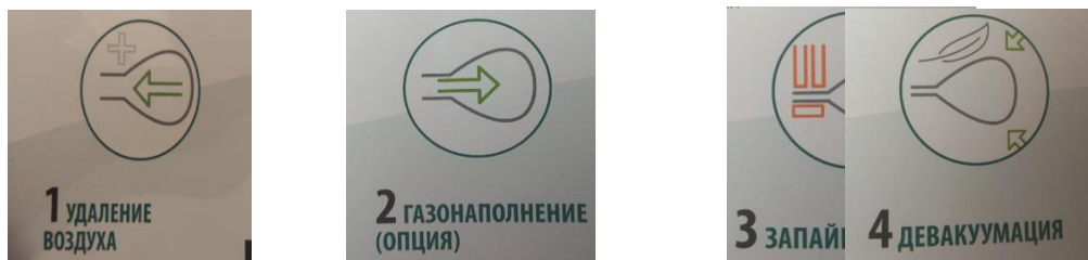
Рис. 1 - Цикл вакуумной упаковки
