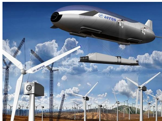
Рисунок 13. Дирижабли для перевозки массивных и габаритных грузов – «Aeroscraft» (компания Worldwide Aeros, США)
