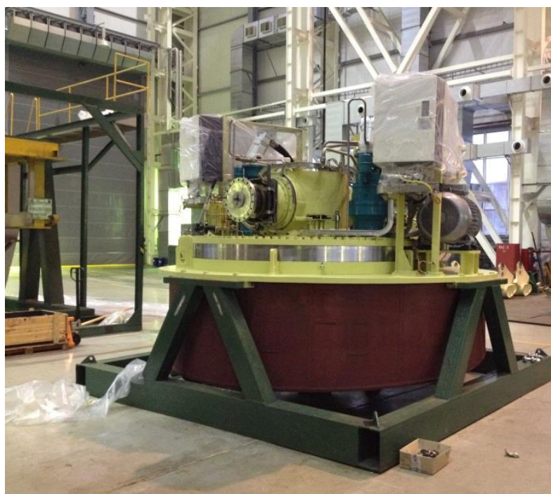
Рисунок 8. Механизм поворота ДРК2500 в помещении ППС
