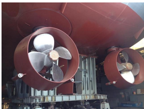
Рисунок 6. ДРК мощностью 2500 кВт производства АО «ЦС Звездочка», смонтированные на судне
