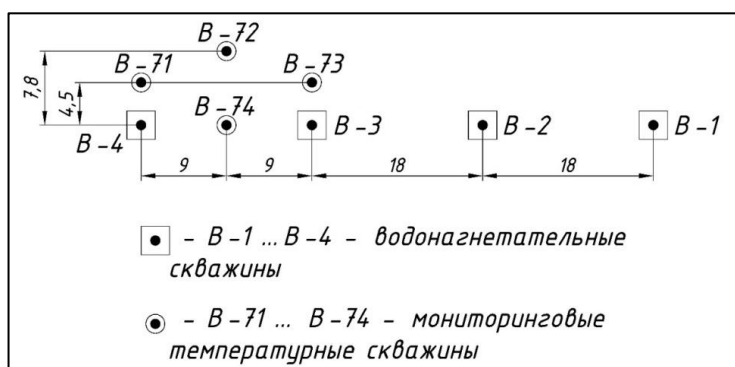
Рисунок 1. Схема размещения водонагнетательных и термометрических скважин на площадке «Б»
