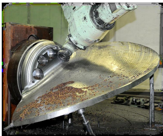
Рисунок 5. Механическая обработка лопасти на фрезерном станке с ЧПУ
