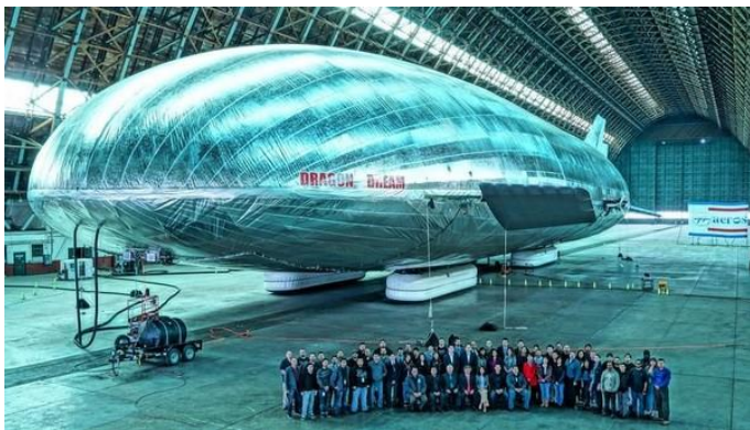
Рисунок 13. Дирижабли для перевозки массивных и габаритных грузов – «Aeroscraft» (компания Worldwide Aeros, США)
