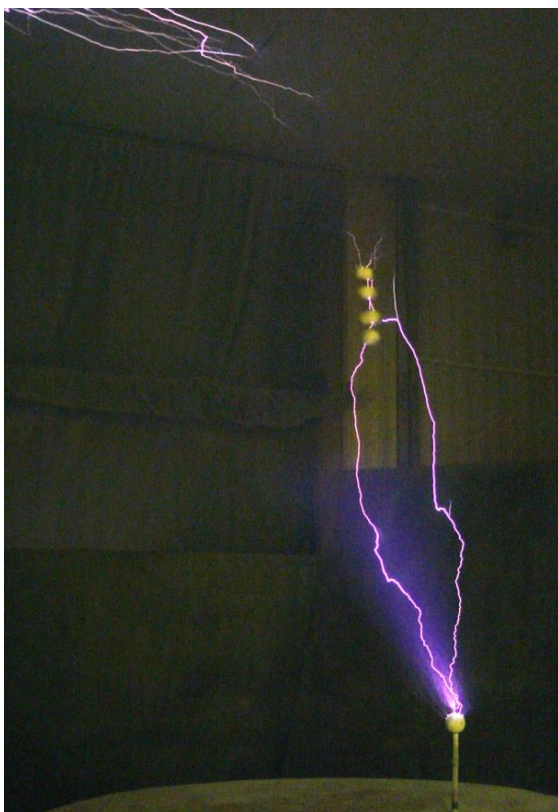
Рисунок 1. Иницирование каналных разрядов между системой отрицательно заряженных грозовых ячеек и землей массивами модельных ГМ
