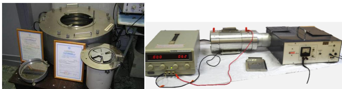
Рисунок 2. Средства поверки измерителей «Поле-2М» и «Электропроводность-2М»
