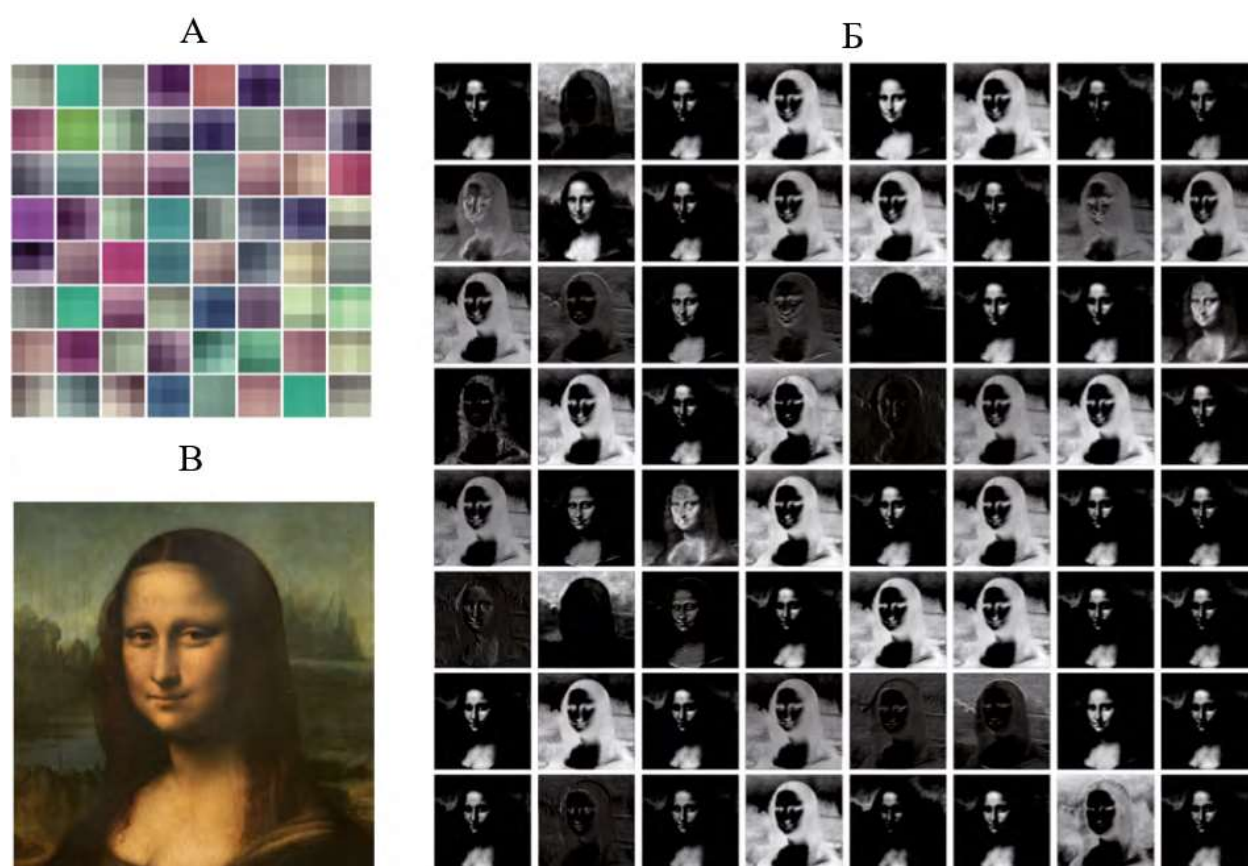
Рис. 5 - Визуализация работы первого сверточного слоя нейронной сети. Визуализация фильтров первого сверточного слоя, размер фильтров 3 \times 3 пиксела, 3 цветовых канала (а). Карты активации первого сверточного слоя, соответствующие приведенным фильтрам, где светлые участки означают максимальную схожесть между фильтром и фрагментом картины, темные — отсутствие активации (б). Оригинальное изображение (в).
